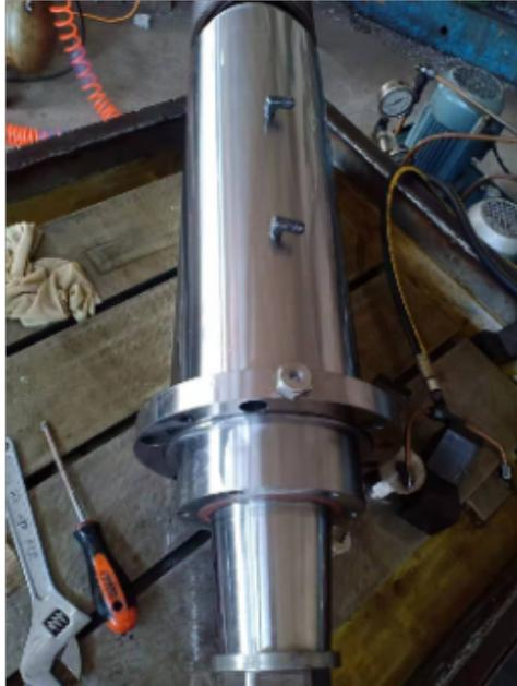
用在高精度机床上的电主轴，不但要求主轴转速高，而且要求其旋转精度也高、并且振动小。因此，在电主轴的设计阶段，必须对它进行动力学特性分析，以确定其各阶临界转速和各阶振型。对于高速轴系，其转子动力学性能的分析与设计是直接决定主轴性能设计的一项重要内容。主轴的转子动力学性能如何，对整台机床能否实现高速加工以及加工精度、主轴轴承的寿命和其它关键部件的正常工作等方面都有着至关重要的影响。另外，陶瓷角接触球轴承具有制造精度高、极限转速高、承载能力强，能同时承受径向和轴向载荷等特点而被普遍地应用于高速机床主轴的支承中。轴承内部各元件的运动及所受载荷比较复杂，特别是高速球轴承中，离心力和陀螺力矩作用的结果使轴承的运转状态发生变化，影响到轴承的变形与载荷关系特性，从而影响到球轴承支撑的转子系统的动力学性能。动静压主轴的散热可以很好地维护电主轴，使动静压主轴可以延长使用时间。河南雕刻机主轴费用
