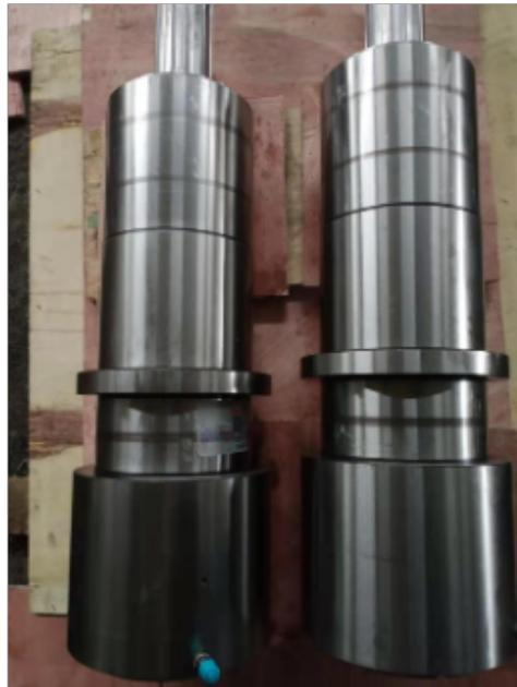
动静压主轴加工的主要问题是保证主轴支承轴颈的尺寸、形状、位置精度和表面粗糙度，以及主轴前端内外锥面的形状精度和表面粗糙度，以及它们对支承轴颈的位置精度。动静压主轴外表面的加工应以中心孔为统一定位基准。然而，在主轴的加工过程中，随着通孔的加工，作为定位基准面的中心孔消失了。在加工过程中，常采用带中心孔的圆锥体塞住主轴两端的孔，使圆锥体的顶孔起到附加定位基准的作用。以支承轴颈为定位基准，将加工好的主轴夹紧在磨床工作台上，以保证主轴锥孔相对于支承轴颈的位置精度。内锥面以轴承轴颈为定位基准进行加工，符合基准重合原则。在精磨前锥孔之前，作为定位基准的支撑轴颈应达到一定精度。主轴锥孔的磨削一般采用夹具，该夹具由底座、支架和浮动卡盘组成。两个支架固定在底座上，作为工件定位基准的两段轴颈放置在支架的两个V形块上，V形块镶有硬质合金，以提高耐磨性，减少工件轴颈上的划痕。
